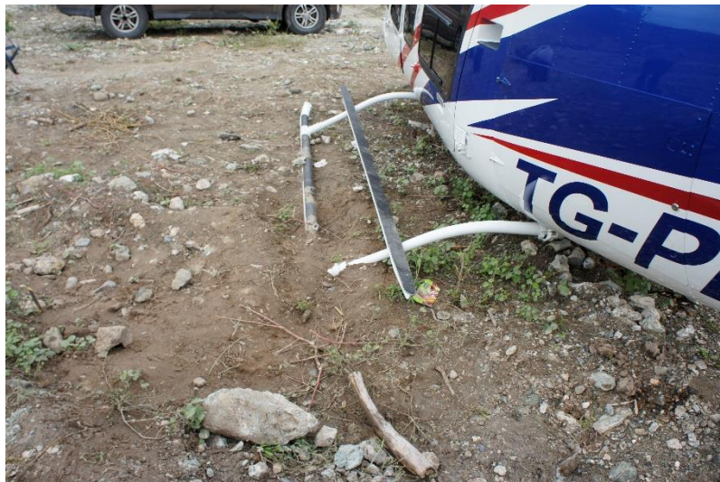
Fotografía No. 4 Vista de la sección de Skid izquierdo enterrado.
