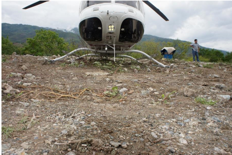
Fotografía No. 9 La sección de fuselaje no muestra daños aparentes.
