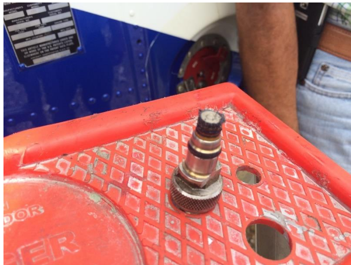
Fotografía No. 14 Detector magnético de partículas de metal del motor.
