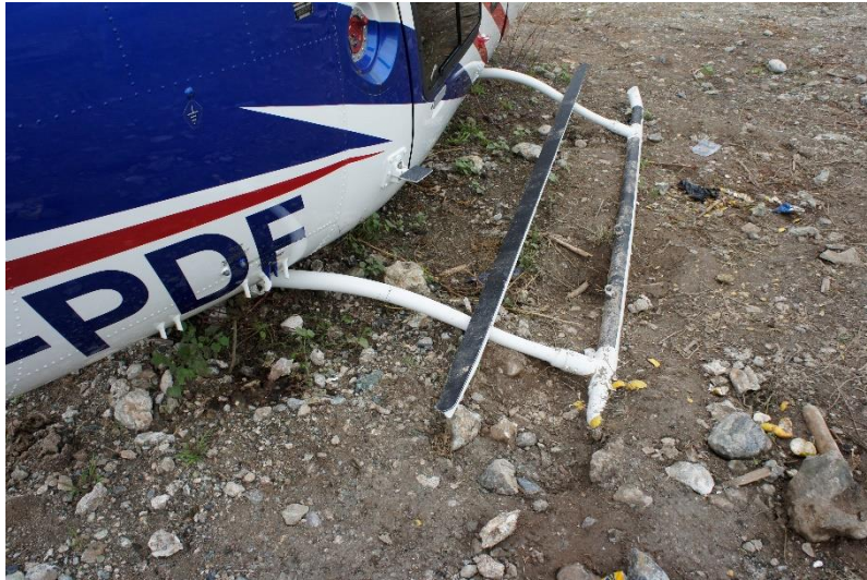
Fotografía No. 5 Sección del skid derecho enterrado.
