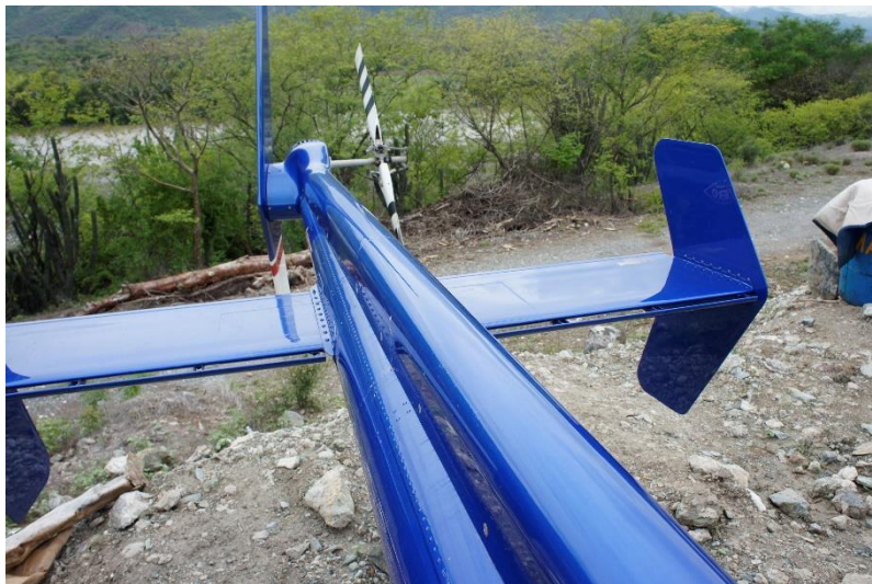
Fotografía No. 10 Vista del cobertor del eje de transmisión de potencia, sin daño.
