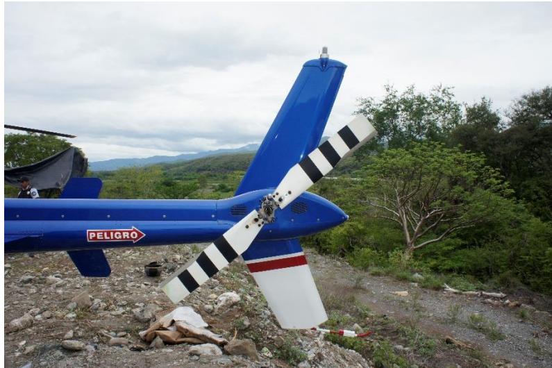
Fotografía No. 7 Rotor y sección de cola sin daños visibles.
