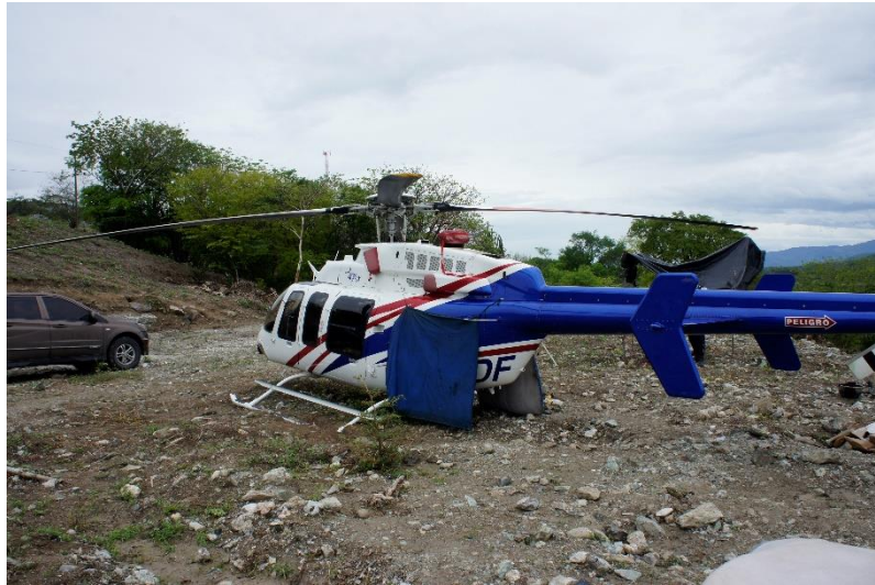
Fotografía No. 3 Sección lateral izquierda sin daños visibles.
