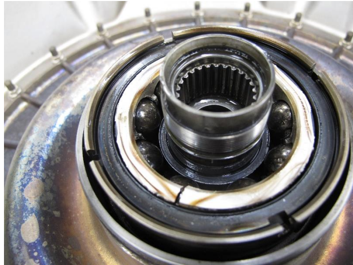
Fotografía No. 15 Vista de la fractura del cojinete No. 2 del motor.
