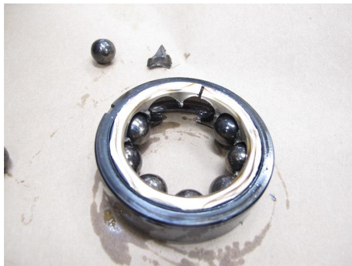
Fotografía No. 16 Vista del cojinete No. 2 con daño total interno.
