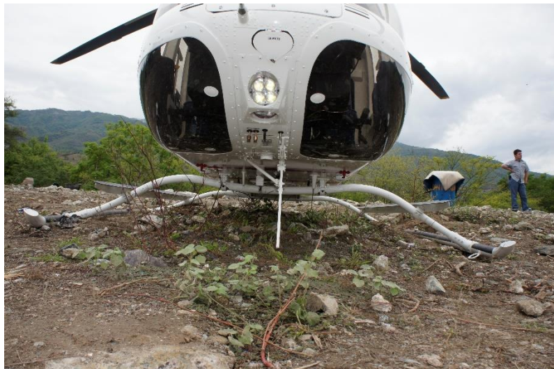
Fotografía No. 8 Tubos cruzados del tren de aterrizaje abiertos por compresión.
