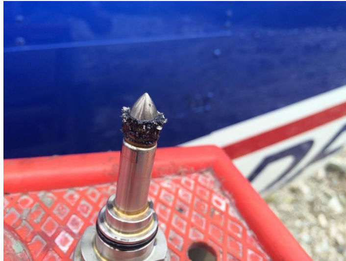
Fotografía No. 13 Detector magnético de partículas de metal del motor.
